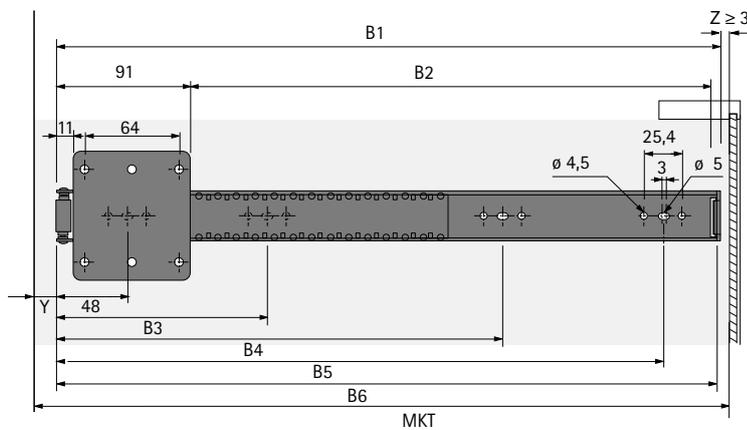
Монтажная глубина (Y) = толщина двери (TD) + 2 мм
